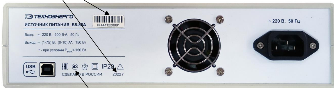
Рисунок 2 – Задняя панель источника питания с обозначением мест нанесения заводского номера, даты выпуска и знака утверждения типа
